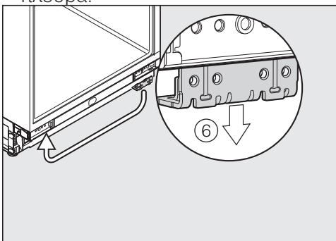
■ Αφαιρείτε τραβώντας τη γωνία στερέωσης κάτω ⑥ δεξιά και μεταθέτετε τη γωνία στερέωσης στην αριστερή πλευρά.
