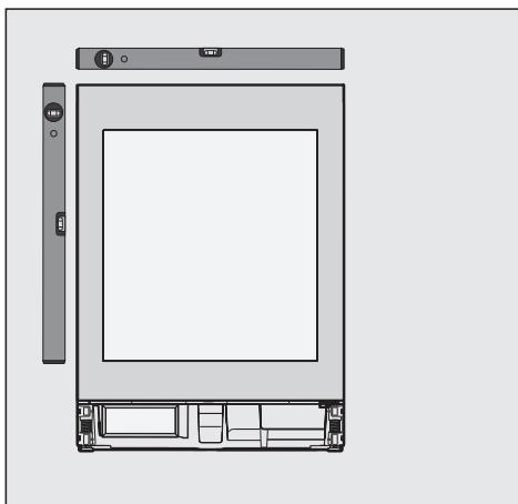
Ευθυγραμμίζετε τη συσκευή οριζοντίως και καθέτως. Μια συσκευή που έχει τοποθετηθεί λοξά μπορεί να παραμορφωθεί.
